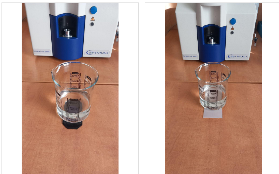
Photos. Dispositifs O MIRA + eau placés en chambre de mesure (luminomètre Berthold).
